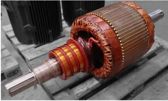
Fig. 1 – Rotor bobinado, com núcleo magnético, anéis coletores e partes mecânicas [9].
