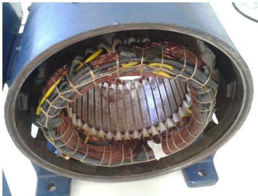
Fig. 10 – Motor pronto, após a rebobinagem.
