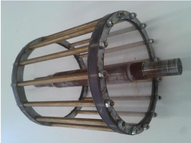
Fig. 12 – Rotor do tipo D montado, pronto para os testes.
