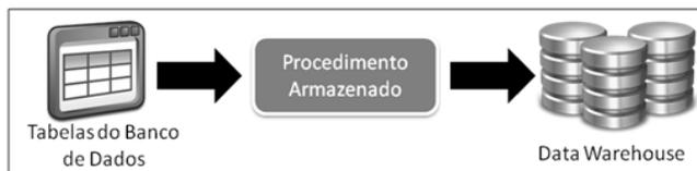
Figura 10. Processo de carga das tabelas do *Data Warehouse*
