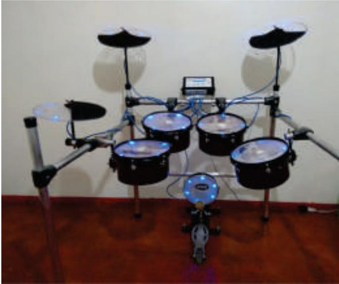
Fig. 1. Protótipo da bateria eletrônica, composta de pads e do módulo MIDI, finalizada.
