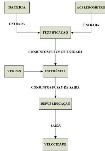
Figura 8. Diagrama do Processo de Inferência Fuzzy. Extraído e Adaptado de: [19]
