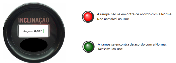
A Norma ABNT 9050 determina que rampas de acesso devam possuir no máximo 8,33% de inclinação. Dessa maneira, inclinações superiores a 4,76° estão inacessíveis.
