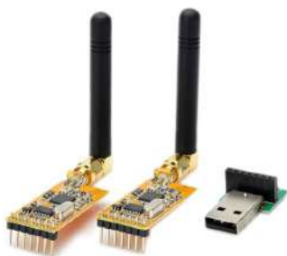
Fig. 9. Módulo RF APC220 e adaptador USB. Fonte: Retirado do [7], 2022.
