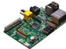
Fig. 4 – Raspberry Pi modelo B
