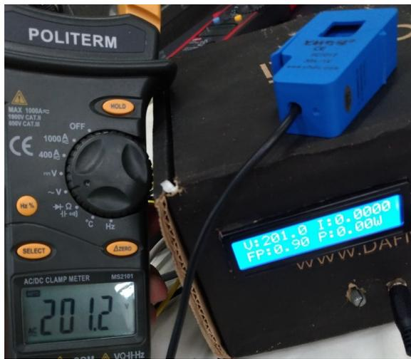
Figura 11. Comparação da medição com o valor do voltímetro.
