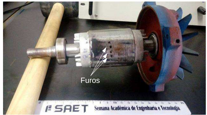
Fig. 3: Cada orifício é uma barra de condução seccionada.
