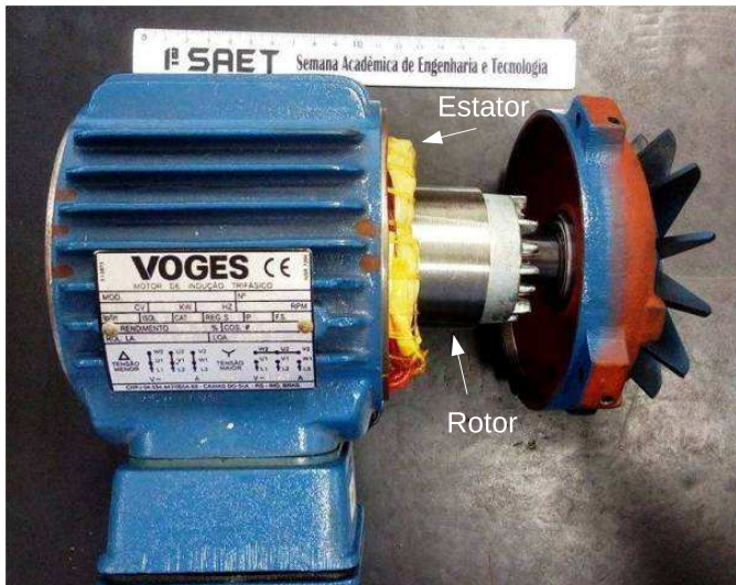
Fig. 1: MIT com suas principais partes, o rotor e o estator.
