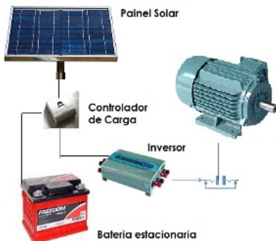
Fig. 9. Sistema de geração fotovoltaica *off grid* típico.
