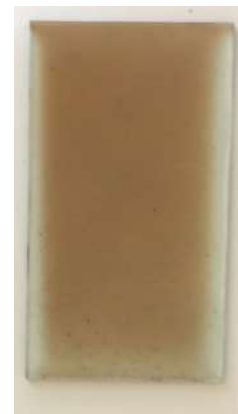
Fig. 1. Vidro protetor acoplado à câmera de robô de soldagem automatizado após quarenta minutos de processo de solda
